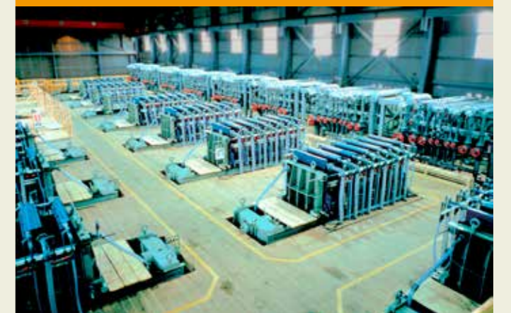
海水濃縮製塩 CS-5型 電気透析槽 (1,800対) / 9,280m 2 CS-5 electro dialyzer (1,800 cell pairs) / 9,280m 2
